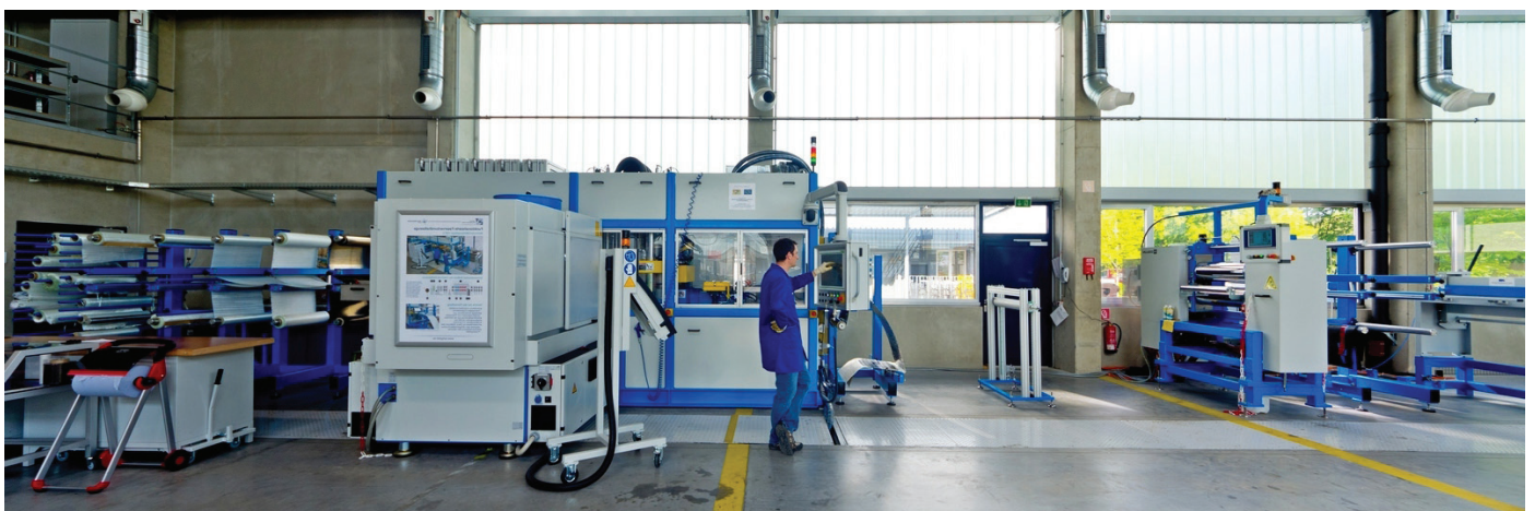
Mehrschichtfolienanlage im Technikum der Neue Materialien Fürth GmbH
